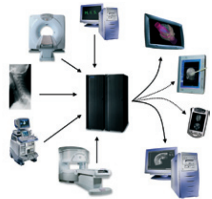
Figur 1: Opbygningen af EasyViz. Man sender billederne til en central computer, der udfører alle manipulationer. Det resulterende billede streames til en almindelig pc eller PDA.
